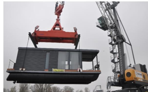
Zu Wasser lassen eines Hausbootes mittels des eigenen Hafen-Mobilkrans.
