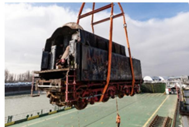
Umschlag einer alten Dampflokomotive von der Schiene auf einen schwimmenden Ponton. Kranhub durchgeführt von einem externen Dienstleister.
